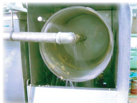
清澄な処理水とスラッジをロータで分離します。
