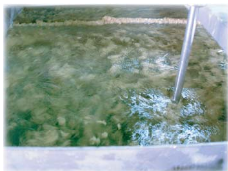
攪拌槽で廃液と凝集剤を攪拌するとフロックを形成します。
